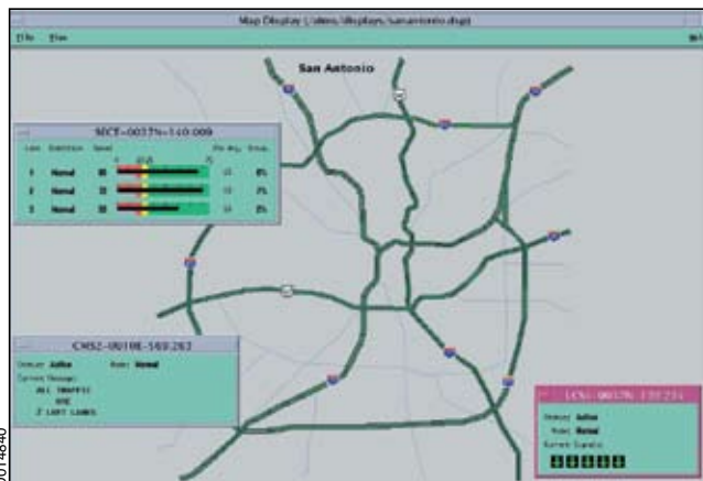
Con el apoyo de financiamiento interno del SwRI, los ingenieros de software convirtieron los archivos estándares de datos GIS a un formato que se visualiza y manipula con mayor facilidad en las pantallas de ATMS.
