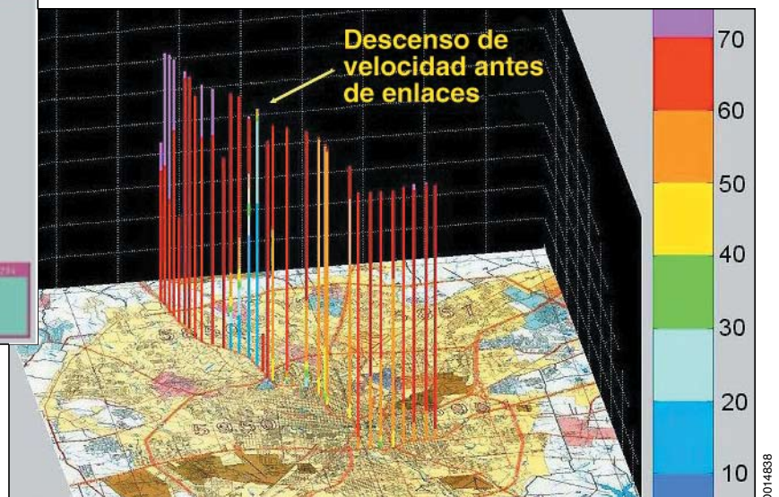
El sistema de extracción de datos puede visualizar muchos tipos de datos de ITS en el tiempo y el espacio.
