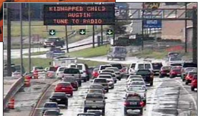
Los ingenieros de software de SwRI han diseñado y usado subsistemas de señales de mensajes dinámicos (dynamic message sign, DMS) en muchos centros de administración de tránsito (traffic management centers, TMC). Estos subsistemas combinan diferentes protocolos DMS para proporcionar a los operadores de TMC un funcionamiento perfecto a la hora de mostrar mensajes públicos, tales como Alertas de AMBER (America's Missing: Broadcast Emergency Response; Por ejemplo, niños desaparecidos).
